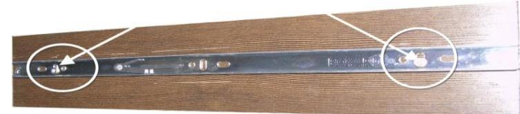
3) Оставшуюся часть направляющей крепим с помощью саморезов 3,5x16.К стойке тумбы.
